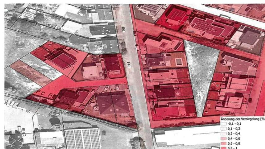
Abb. 6: Detailansicht einer Flurkarte (Einfärbung der Veränderung des Versiegelungsgrades der Flurstücke von niedrig bis hoch in Weiß bis Rot)
