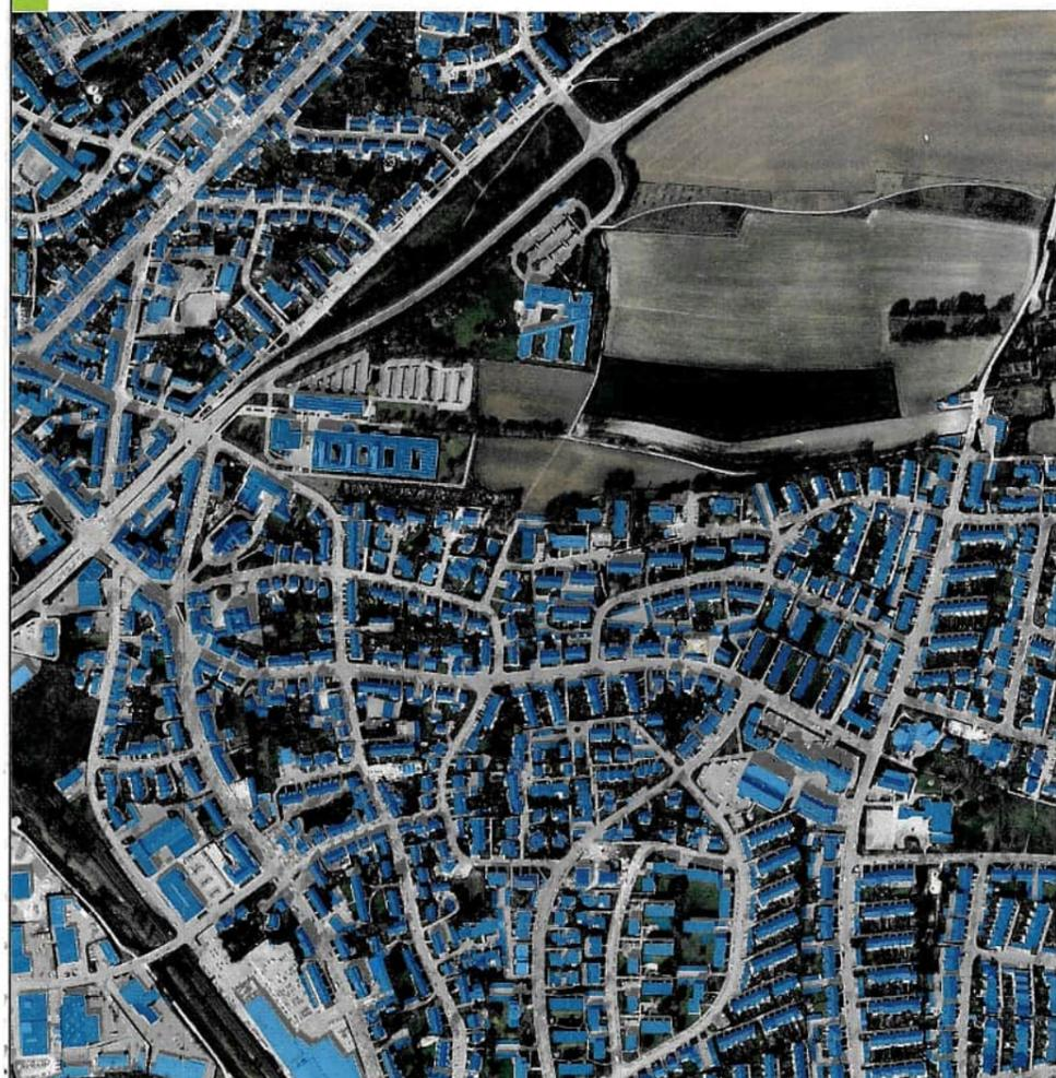
Abb. 1: Detailansicht einer automatisch generierten Versiegelungskarte (versiegelte Flächen durch Hoch- und Tiefbau werden in Blau bzw. Grau eingefärbt)
