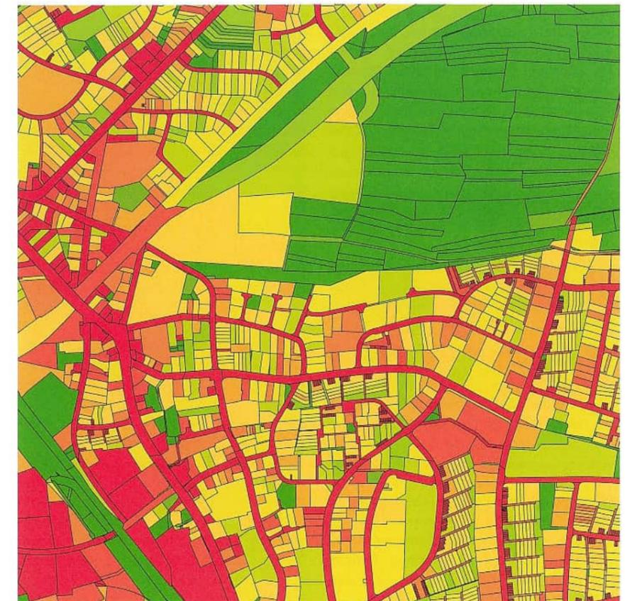
Abb. 3: Detailansicht einer Flurkarte (Einfärbung des Versiegelungsgrades der Flurstücke von niedrig bis hoch in Grün bis Rot)
